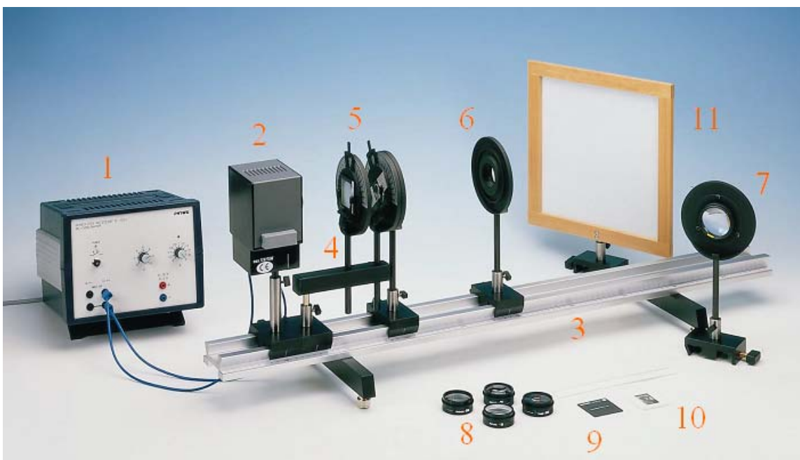
Figura 6. Dispozitivul experimental utilizat pentru determinarea distanțelor focale ale lentilelor
