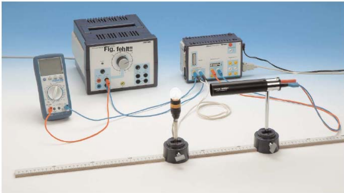
Fig.4. Sistemul de conexiuni pentru trasarea curbei I(T)
