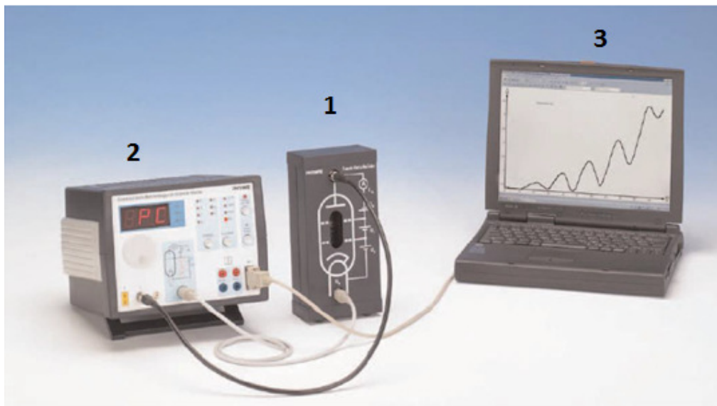
Figura 4: Dispozitivul experimental Franck-Hertz [4]
