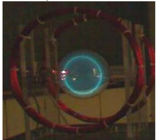
Fig. 4 Vedere a bobinelor Helmholtz și a traiectoriei electronilor
