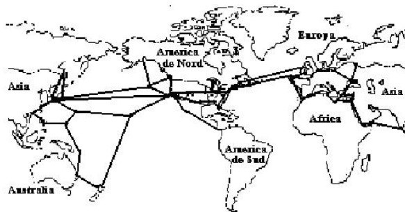
Fig. 12. 3. Rețea transoceanică de cabluri optice.
