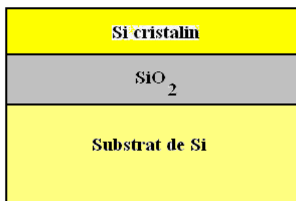
Fig. 2. 23. Reprezentarea structurii de tip sandwich formată din Si cristalin, \text{SiO}_2 și un substrat izolator din Si.
