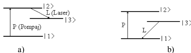
Fig. 8. 1. a), b). Scheme cu trei nivele pentru realizarea inversiei de populație prin pompaj optic.
