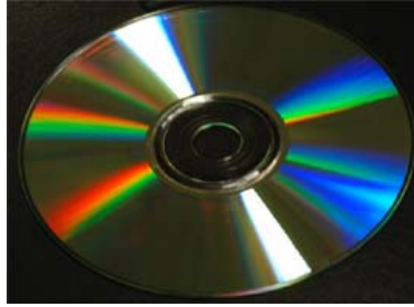
Fig. III. 15. Microcanalele (trăsăturile) de pe un CD acționează ca o rețea de difracție ducând la separarea componentelor luminii albe.
