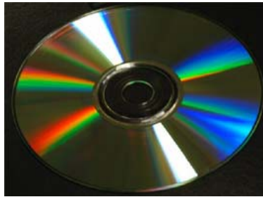
Fig. III. 13. Microcanalele (trăsăturile) de pe un CD acționează ca o rețea de difracție ducând la separarea componentelor luminii albe.
